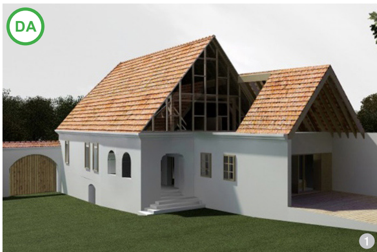
ASA DA: Intervenție posibilă pentru clădiri tradiționale cu valoare arhitecturală. S-a reușit amenajarea unei terase circulabile fără să se modifice consistent imaginea de ansamblu a acoperișului. (Copșa Mare, jud. Sibiu)
